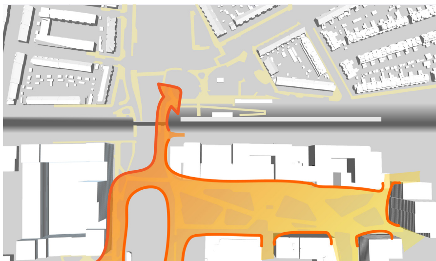
Veel voetgangers gebruiken de smalle onderdoorgang aan de oostkant van het viaduct.
