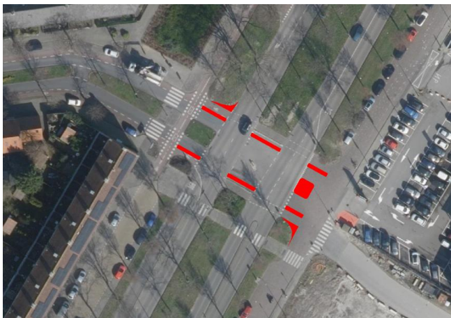
Figuur 32: Plaatsing van geleiders tussen fietsvoorzieningen en de rijbaan, ter bescherming van fietsverkeer en veiligere aansluiting van de oostelijke parallelweg
